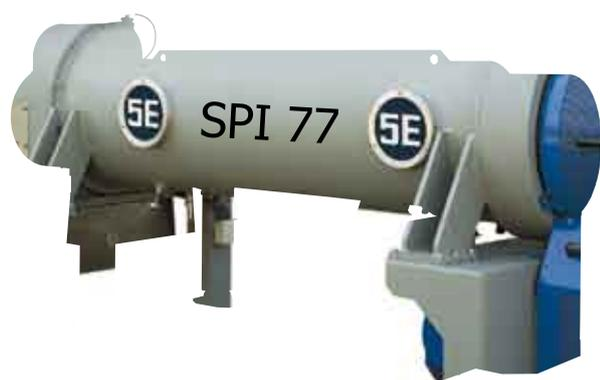
Depuis quelques années Pieralisi a mis au point une nouvelle série de décanteurs nommée **Série SPI pour l'extraction de l'huile d'olive avec une méthode à deux phases**. On pourrait même dire que l'extracteur centrifuge Pieralisi SPI est le décanteur deux-phases «par excellence».
